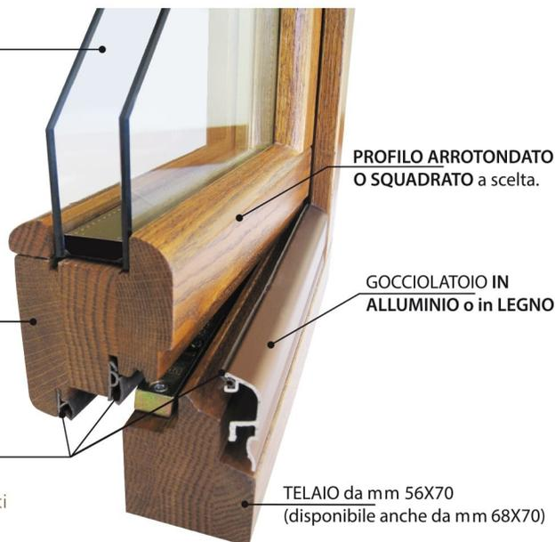
Le nostre finestre prodotte in legno massello o lamellare, vengono realizzate con il tradizionale sistema "Doppio Tenone" che garantisce tenuta e stabilità nel tempo.
